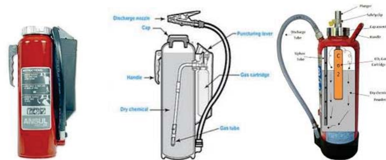
ภาพที่ 7.4 เครื่องดับเพลิงผงเคมีแห้งแบบบีบดันด้วยก๊าซบรรจุในท่อ (CARTRIDGE OPERATED)
